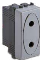
33182 Preso 2P 16A 250V, fori Ø 4,8 mm, Steel
