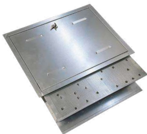
TF700 Collettore metallico da incasso o superficie per alimentatori ThermoFloor con lato inferiore aperto per ingresso cavi e portello frontale con serratura. 2 barre DIN. Dimensioni 596x625x152 mm.
