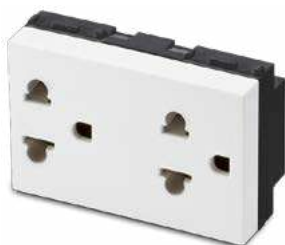
21188.3 Doppia presa 2P+T 16A 250V~ Euroamericana, con sicurezza, 3 moduli
