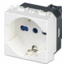
21170-AB Presse P40 "universale" a ricettività multipla 2P+T 16A 250V~, con sicurezza
