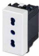
21159-AB Presse P17/11 2P+T 16A 250V~ bivalente, con sicurezza
