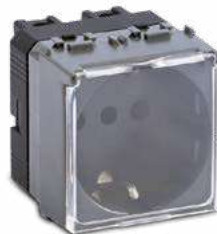
33174 Preso Schuko P30 2P+T 16A, terra laterale e centrale, con portello IP40, Steel
