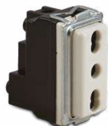
16059 Presse P17/11 2P+T 16A 250V~ "bivalente" con alveoli schermati
