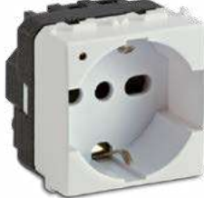
36170-L Presse P40 "universale" a ricettività multipla 2P+T 16A con LED blu di segnalazione, 230V~, bianco
