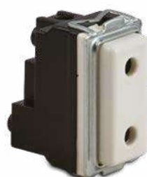
6061-S Presa P10 2P 10A fori Ø 4mm con alveoli schermati
