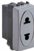
33185 Preso 2P 16A 250V~ Euroamericana, fori Ø 4,8 mm, Steel
