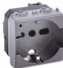
33170-L Preso P40 "universale" a ricettività multipla 2P+T 16A con LED blu di segnalazione, 230V~, Steel
