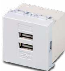
21213.2 Unità di alimentazione per dispositivi elettronici USB con 2 prese tipo A femmina, 5V 4A totali, alimentazione 100-240V~ 50/60Hz, 2 moduli, bianco
