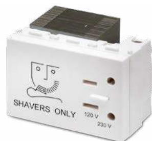
21190-AB Presse rasoio con trasformatore d'isolamento 20 VA, alimentazione 230V~, uscita 127 V~ per spine 2P 15A standard americano e uscita 230V~ per spine 2P 2,5 A, 3 moduli
