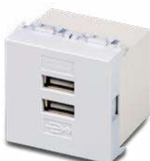
21213.2-AB Unità di alimentazione per dispositivi elettronici USB con 2 prese tipo A femmina, 5V 4A totali, alimentazione 100-240V~ 50/60Hz, 2 moduli, bianco
