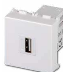
21214.2 Unità di alimentazione per dispositivi elettronici USB con presa tipo A femmina, 5V 2.1A, alimentazione 100-240V~ 50/60Hz, 2 moduli, bianco
