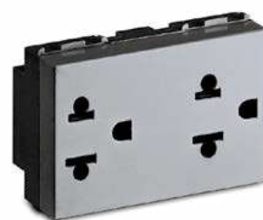
33188.3 Doppia presa 2P+T 16A 250V~ Euroamericana, 3 moduli
