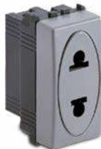
33185-4 Preso 2P 15A 250V~ Euroamericana, fori Ø 4 mm, Steel
