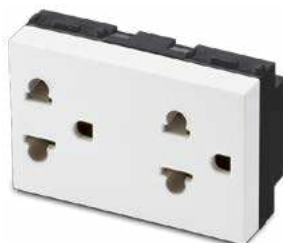
21188.3-AB Doppia presse 2P+T 16A 250V~ Euroamericana, 3 moduli, con sicurezza
