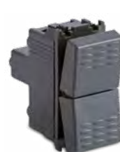
31022 Doppio-pulsante 1P NO/NC + 1P NO/ NC (6 morsetti) 16A 250V~ con interblocco, grigio
