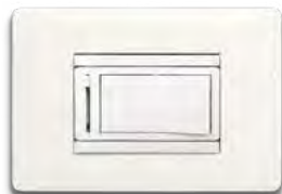
MK21055 Dimmer 127V~ 60Hz con deviatore per lampade a incandescenza max 600W e CFL/LED regolabili max 150W.
