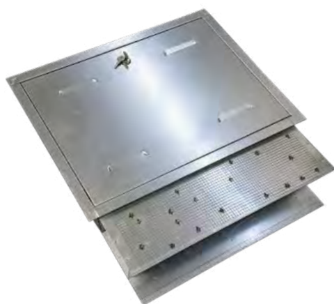
TF700 Collettore metallico da incasso o superficie per alimentatori ThermaFloor con lato inferiore aperto per ingresso cavi e portello frontale con serratura. 2 barre DIN. Dimensioni 596x625x152 mm.
