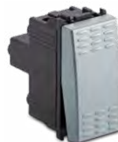
33060 Apparecchio multifun- zione (interruttore 1P, interruttore 2P, deviato- re 1P, pulsante NO/NC) 16AX 250V~, Steel
