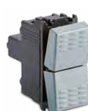
33022 Doppio-pulsante 1P NO/NC + 1P NO/ NC (6 morsetti) 16A 250V~ con interblocco, Steel
