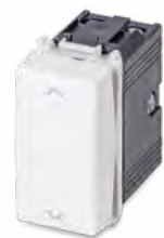
21036 Commutatore a tre posizioni (1-OFF-2) 1P 10AX (3 morsetti) 250V~
