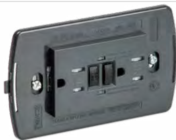
31184.3 Doppia presa 2P+T 16A 250V~ Americana con GFCI, grigio, con supporto incluso. Da completare con placca 3 moduli.
