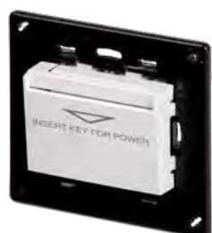
HA05213 ☼ Tasha: inseritore per tessere badge con NFC per attivazione servizi stanza, funzionamento via bus UNA Automation, con supporto per scatola tonda e quadrata, da completare con placca 2.5 moduli
