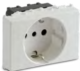
36173 Presa UNEL P30 2P+T 16A, terra laterale e centrale, 3 moduli, bianco
