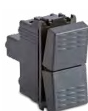
31021 Doppio-pulsante 1P NO/NC + 1P NO (5 morsetti) 16A 250V~ con interblocco, grigio
