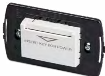
HA05313 ☼ Tasha: inseritore per tessere badge con NFC per attivazione servizi stanza, funzionamento via bus UNA Automation, con supporto per scatola unificata 3 moduli, da completare con placca 3 moduli
