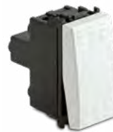
36060 Apparecchio multifun- zione (interruttore 1P, interruttore 2P, deviato- re 1P, pulsante NO/NC) 16AX 250V~, bianco
