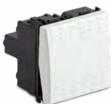
36060.2 Apparecchio multifunzione 2 moduli (interruttore 1P, interruttore 2P, deviatore 1P, pulsante NO/NC) 16AX 250V~, bianco
