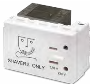
21190-AB Preso rasoio con trasformatore d'isolamento 20 VA, alimentazione 230V~, uscita 127 V~ per spine 2P 15A standard americano e uscita 230V~ per spine 2P 2,5 A, 3 moduli
