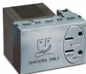
33190 Presa rasoio con trasformatore d'isolamento 20 VA, alimentazione 230V~, uscita 127 V~ per spine 2P 15A standard americano e uscita 230V~ per spine 2P 2,5 A, 3 moduli, Steel
